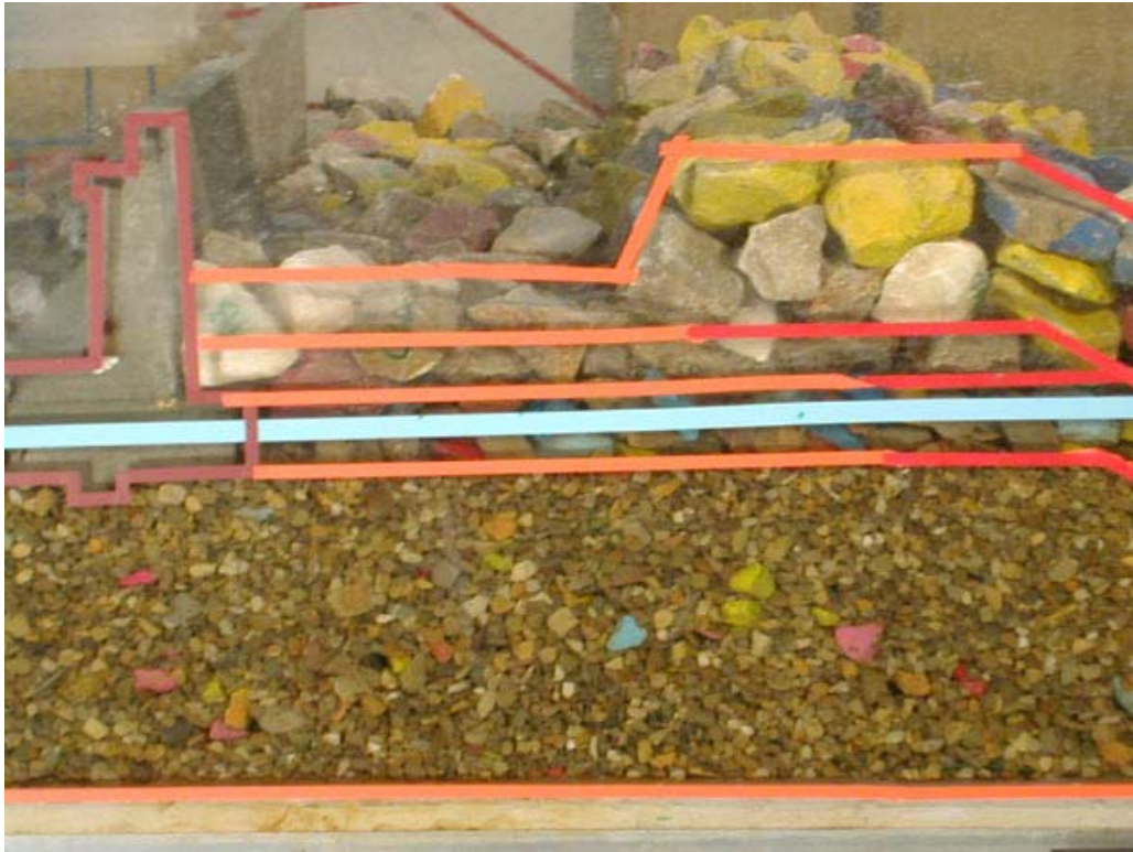
Foto 3 – Configurazione 1, variante 1: particolare vasca di dissipazione.
