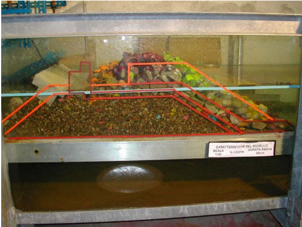
Foto 5 – Configurazione 2: ribaltamento muro paraonde.
