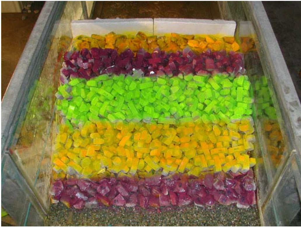
Foto 6 – Configurazione 2, variante 1: particolare mantellata.
